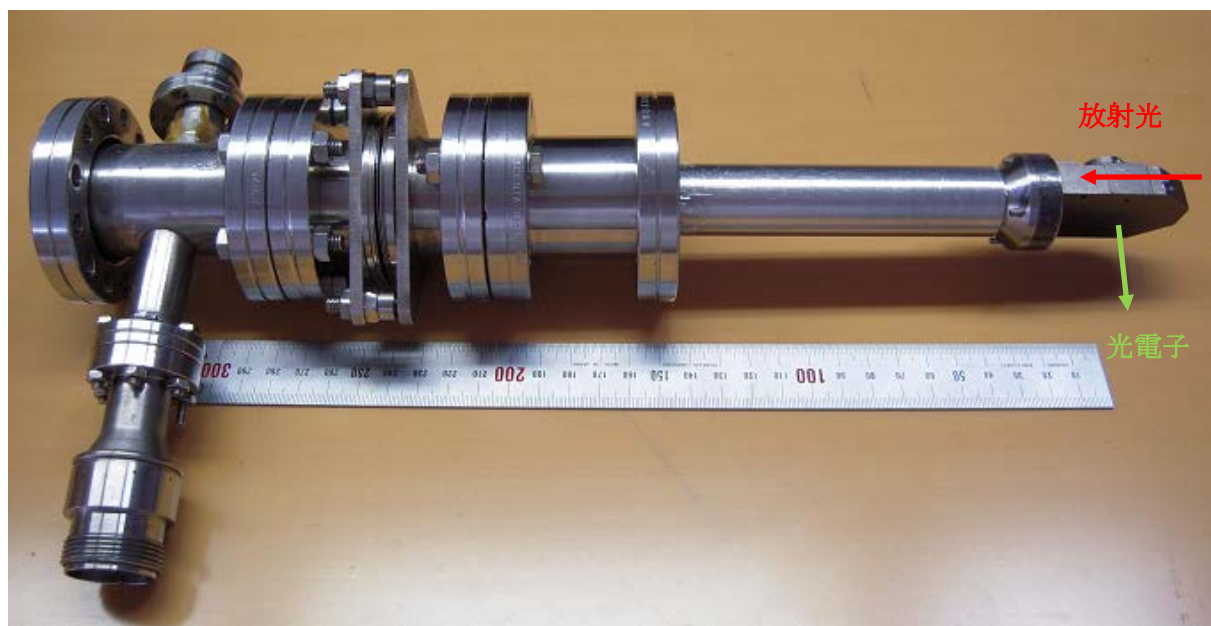
図3. 本研究で用いられた専用ガスセル GC50。右側から左に向かって、放射光が入射し、図のように光電子が放出される。実際の長さは、真空槽の長さに合わせて調整されている。
