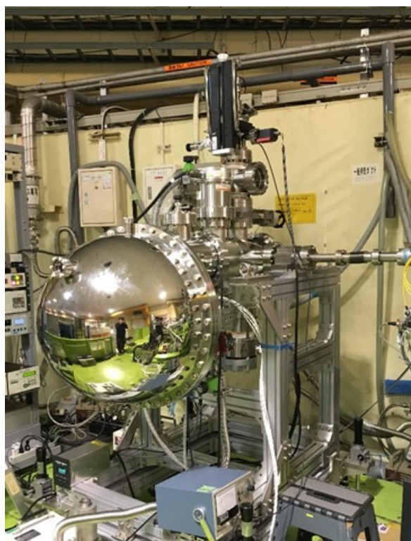
図 7. KEK-PF BL20A 真空紫外線ビームラインに設置された電子分光装置 SCIETA R4000 とイオン液体標的を設置した直線導入部。
