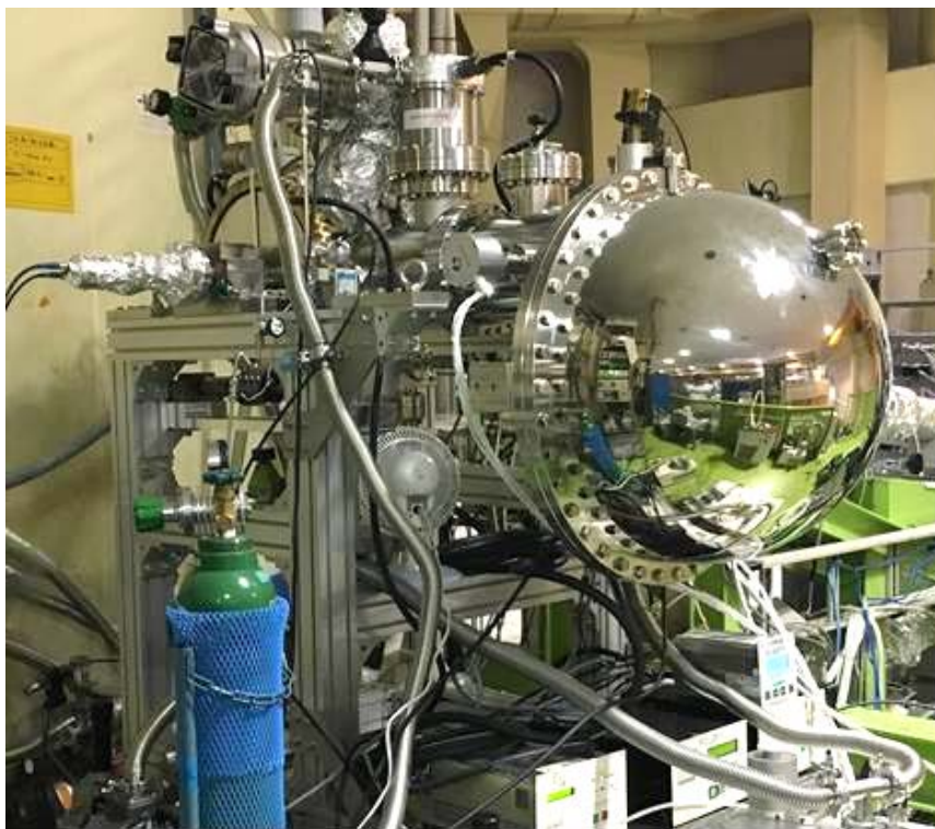
図 1. フォトンファクトリー-BL20A に設置された SCIENTA R4000 の写真。右側の半球部分が、平均軌道半径 200 mm のエネルギー分析器部分である。
