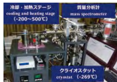
本研究室で開発した低温昇温脱離装置 Low-temperature thermal desorption spectrometry apparatus developed in our laboratory
